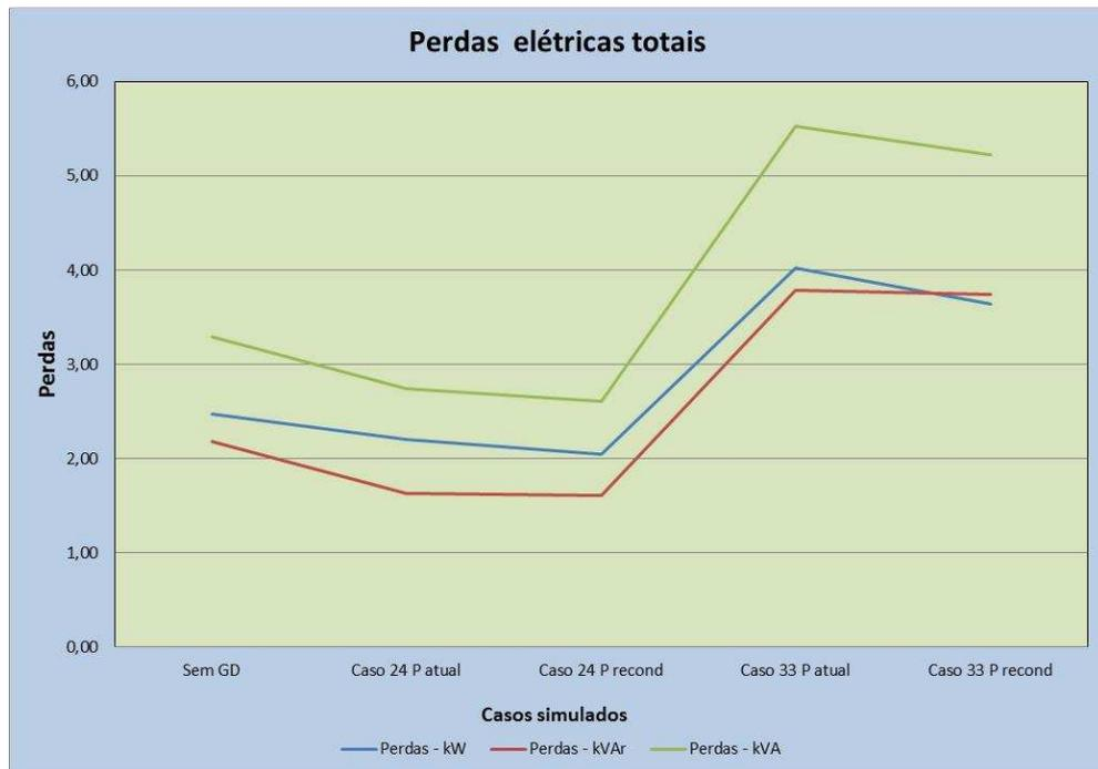
Figura 5.3 – Comportamento das perdas elétricas antes e após recondutoramento – 13,8 kV
