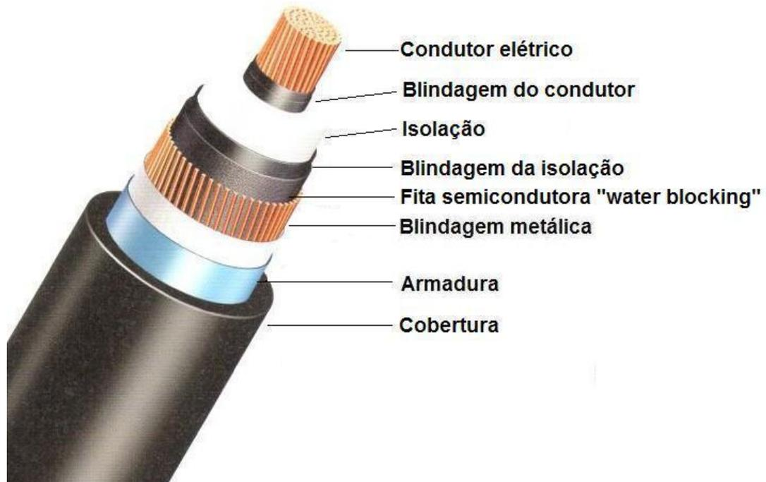
**Figura 2.1** – Cabo elétrico isolado a seco. Adaptado de [48]
