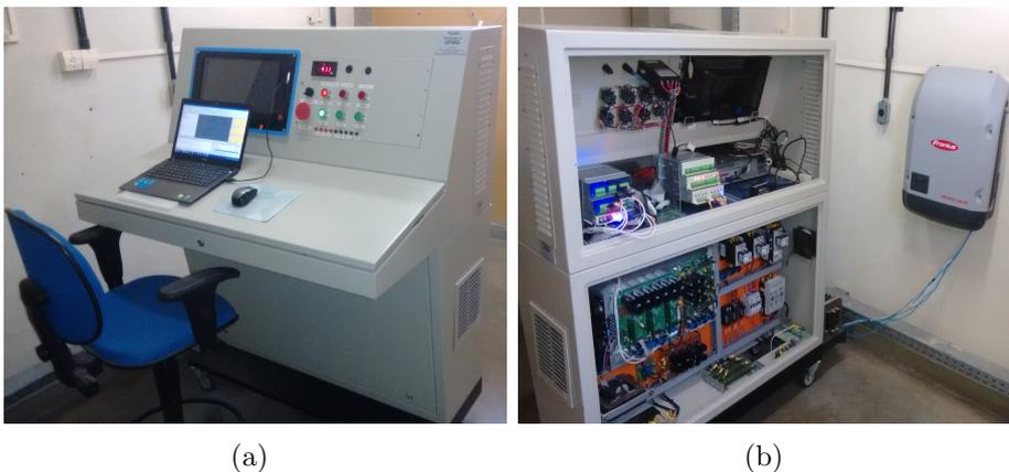
Figura 2.8: Visão geral do protótipo: (a) Painel frontal (Programação e sistema supervisão); (b) Circuitos de controle, potência e inversor sob teste.
