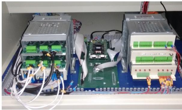
Figura 2.11: Sistema de condicionamento e controle do simulador de painéis.
