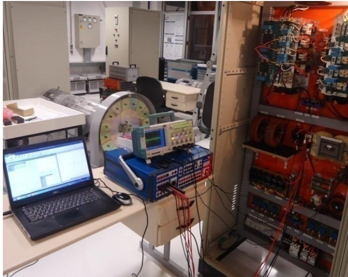
**Figura 3.18: Montagem realizada para identificação do ICT.**
