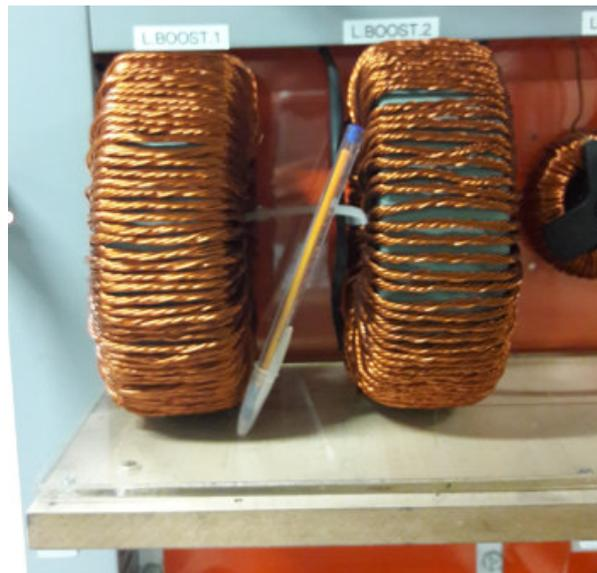
Figura 3.27: Indutores do conversor *Boost* entrelaçado da geração fotovoltaica.
