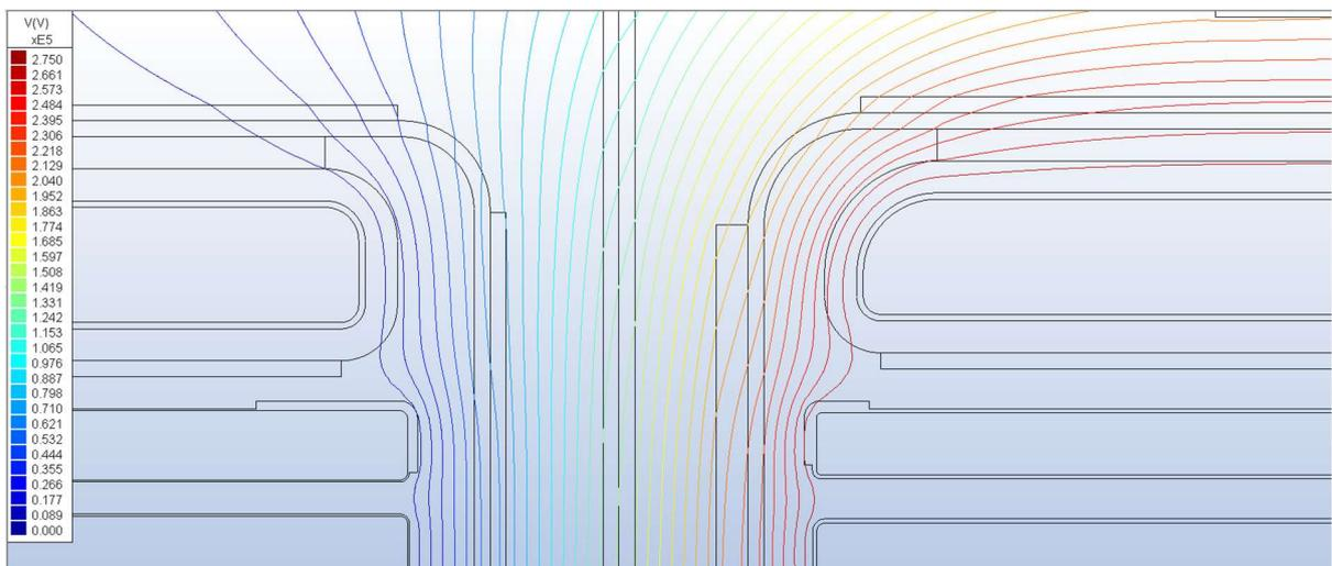
Figura 5.4. Linhas equipotenciais nas extremidades dos enrolamentos
