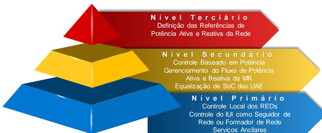
Figura 2.3: Estrutura de Controle Hierárquico da MR Híbrida.
