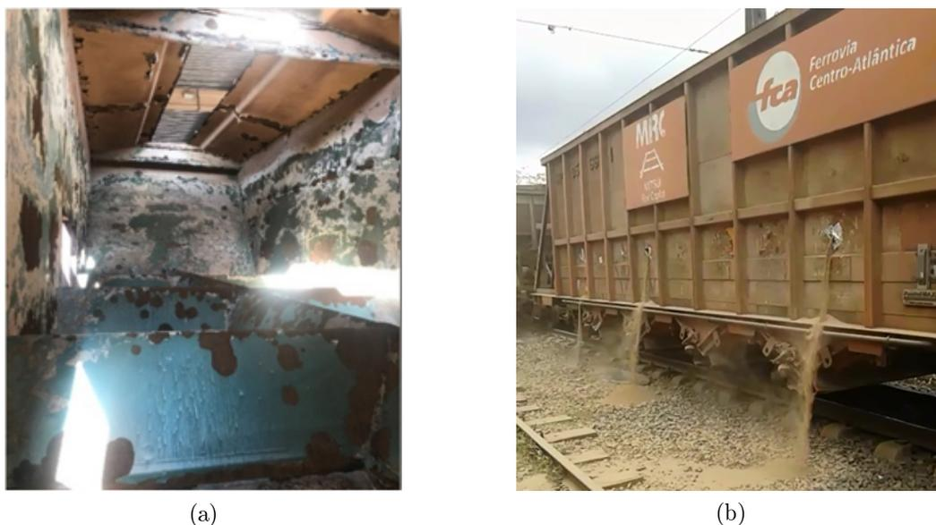
**Figura 3.1.** (a) Pintura Interna Corroída; (b) Vazamento de Produto nos Furos Laterais. Fonte:[VLI, 2018].
