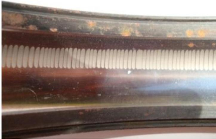
Figura 2.33: Anel externo do rolamento do motor em corte: estrias provocadas por passagem de corrente elétrica.
