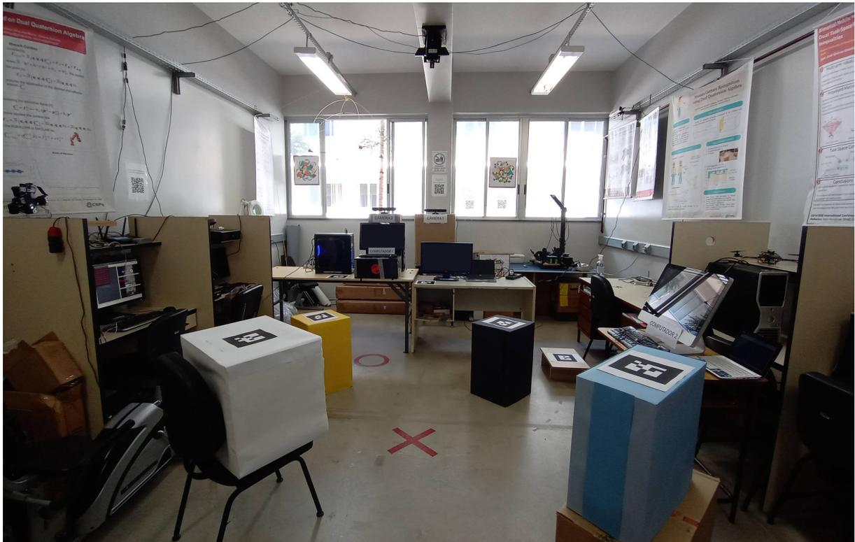
Figura B.4: Ambiente dos experimentos de interação. As quatro caixas coloridas são os objetos a serem indicados e marcações no chão indicam posições para onde participantes devem se direcionar.
