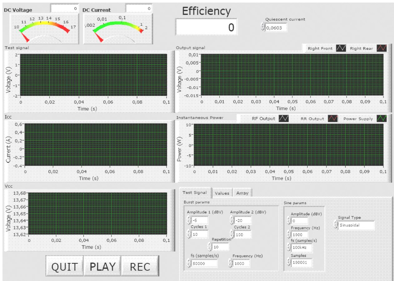
Figura A.7: Painel virtual do sistema de instrumentação – módulo de medição da eficiência.
