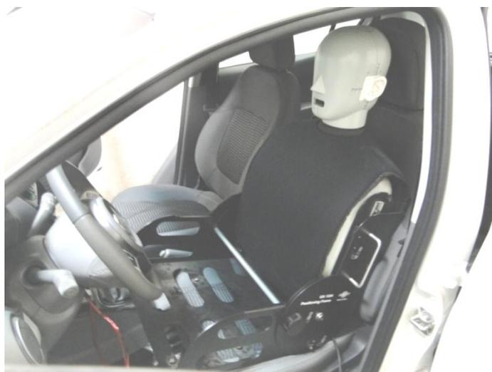
Figura 6.7: Fotografia do HATS instalado no veículo.
