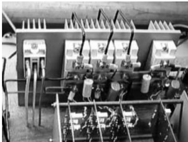
Figura 5.2- Módulo de potência utilizado pelo inversor trifásico.
